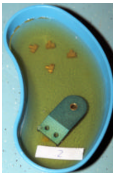
Abbildung 1 In Glycerolgelatine (DAB 9) eingebettete Aluminium- und Messingbauteile zur Artefaktdiagnostik im offenen Magnetresonanztomographen
